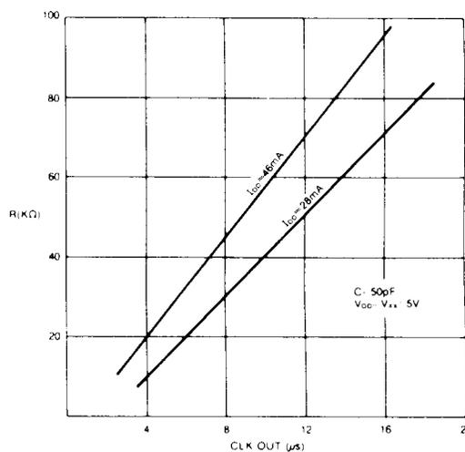
**Figure 3** TYPICAL OSCILLATOR RC CHART @ 25°C
